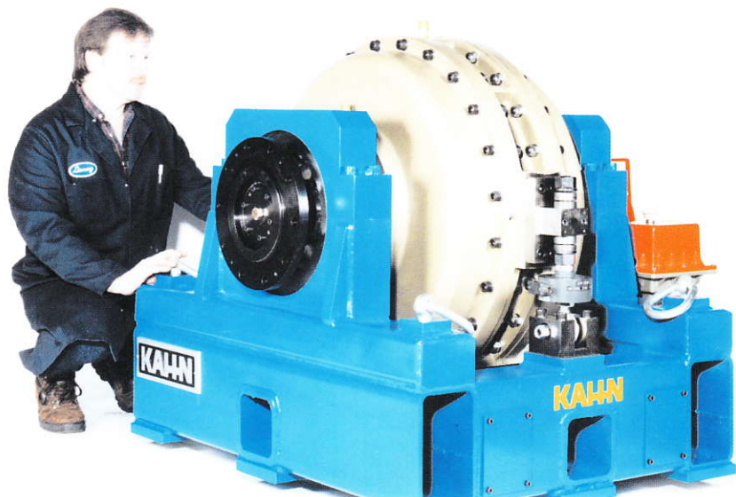
卡恩工业公司 (Kahn Industries) 已将其302系列测功机提供给美国海岸巡逻队，作巡逻艇发动机大修后测试用。
